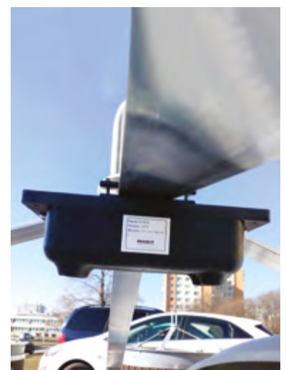
Beispiel der Montage des Sensors am Container
